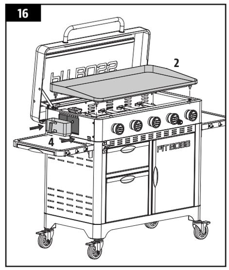
**17. INSTALLING THE IGNITION BATTERY**
