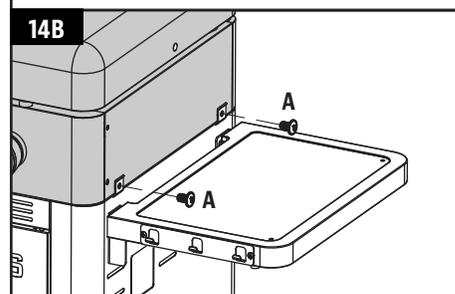
**15. INSERTING THE HOT PLATE SCREWS**
