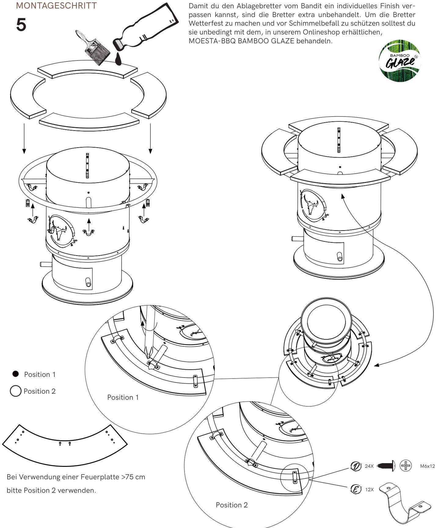
Bei Verwendung einer Feuerplatte >75 cm bitte Position 2 verwenden.
