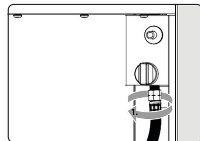
Wasser) ein. Drehen Sie das Ventil der Gasflasche auf. An undichten Stellen zeigen sich Blasen. Drehen Sie das Ventil der Gasflasche wieder zu und beheben Sie den Fehler. Danach wiederholen Sie Schritt 5 bis alle Undichtigkeiten behoben sind.
