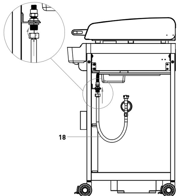
Gasflaschen mit einem maximalen Maß von Ø 30 x 59 cm können verwendet und in dem Grill aufgestellt werden.
